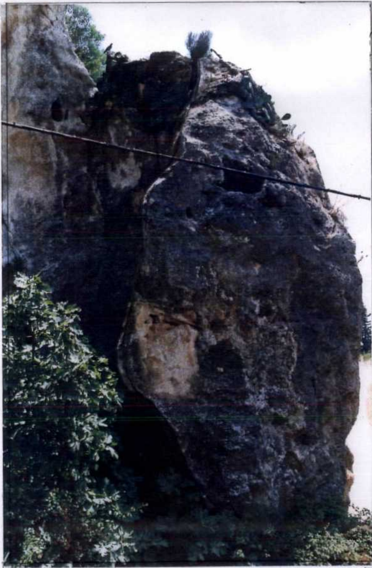
Fotografías 4.1 y 4.2. Vista del bloque inestable de la Zona 4 desde el lado W. con las grietas que lo independizan.
